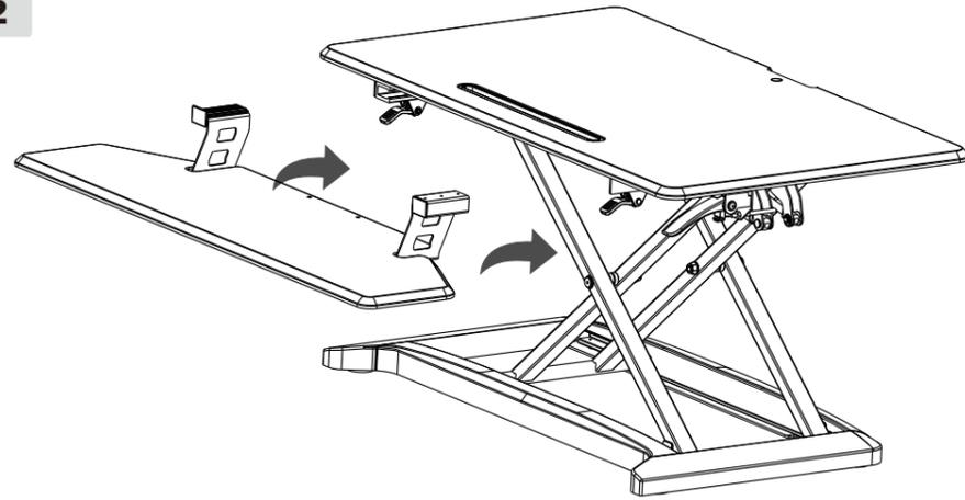
Insérez le support de métal préassemblé du plateau de clavier (A) dans les glissières latérales préassemblées (B) du dessus de la station de travail. Utilisez le loquet pour verrouiller en place (C). (Voir les illustrations)
